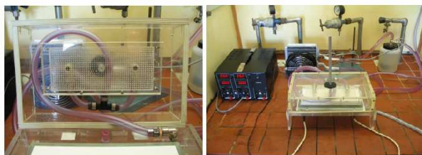
◀Obr.: 4 Reaktor na plazmovú polymerizáciu. Vľavo: kryt reaktoru so "sprchou" na rovnomerné napúšťanie pracovného plynu. Vpravo: celkový pohľad na reaktor s DCSBD výbojkou.
