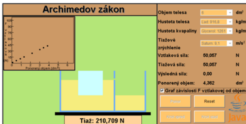
Obrázok 2 Java applet Archimédov zákon zobrazujúci konečný stav simulácie pre hodnoty: V = 6 \text{ dm}^3 ; \rho_t = 916,8 \text{ kg} \cdot \text{m}^{-3} ; \rho_k = 1261 \text{ kg} \cdot \text{m}^{-3} ; g = 9,1 \text{ m} \cdot \text{s}^{-2}
